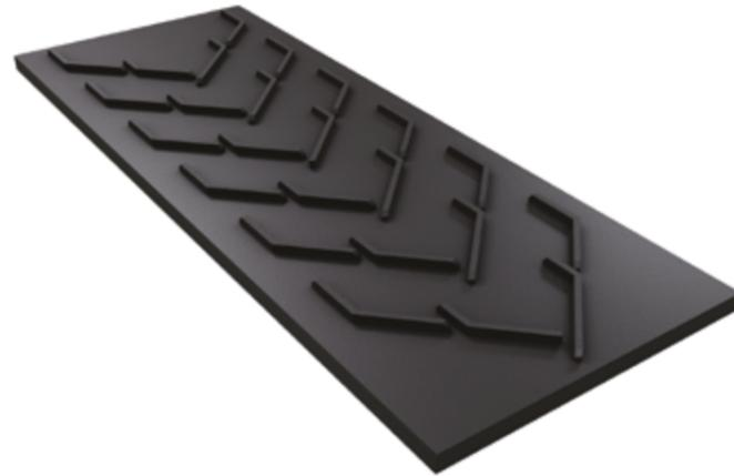
Nos bandes **PRIMA CHEVRONS** sont constituées de 2 à 3 plis de tissu EP (polyester en chaîne et polyamide en trame) imputrescible assurant une excellente résistance rupture de la bande en sens chaîne.
